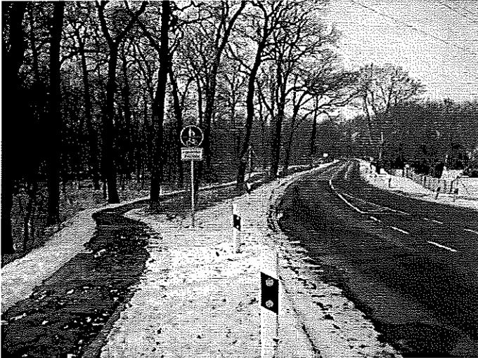
Der Radweg wurde in der Trasse des seit langem vorhandenen unbefestigten Weges in wechselnden Abständen und mit unterschiedlichen Höhendifferenzen zur Fahrbahn hinter den straßenbegleitend vorhandenen Bäumen ausgebaut. Durch die Nutzung des vorhandenen Weges wurde der Eingriff in die Natur in diesem sensiblen Raum erheblich reduziert. Der Radweg dient vorrangig Tourismus und Naherholung und wird deshalb zu einem hohen Anteil tagsüber genutzt.
